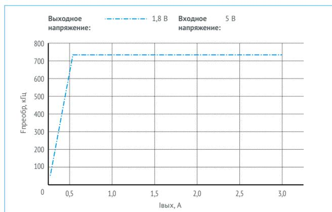
Рис. 5. Зависимость частоты преобразования от тока нагрузки.
