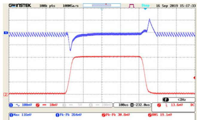
Рис. 8.  $I_{OUT} = 0,1-3 \text{ A}$ ;  $0,1 \text{ A/мкс}$ .
