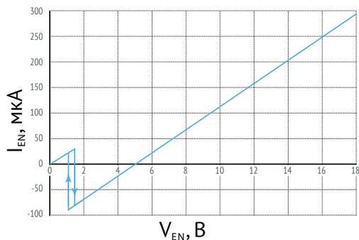
Рис. 15. Типовая кривая втекающего/вытекающего тока по выводу EN в зависимости от напряжения на нем.  $V_{IN} = 18 \text{ В}$ .
