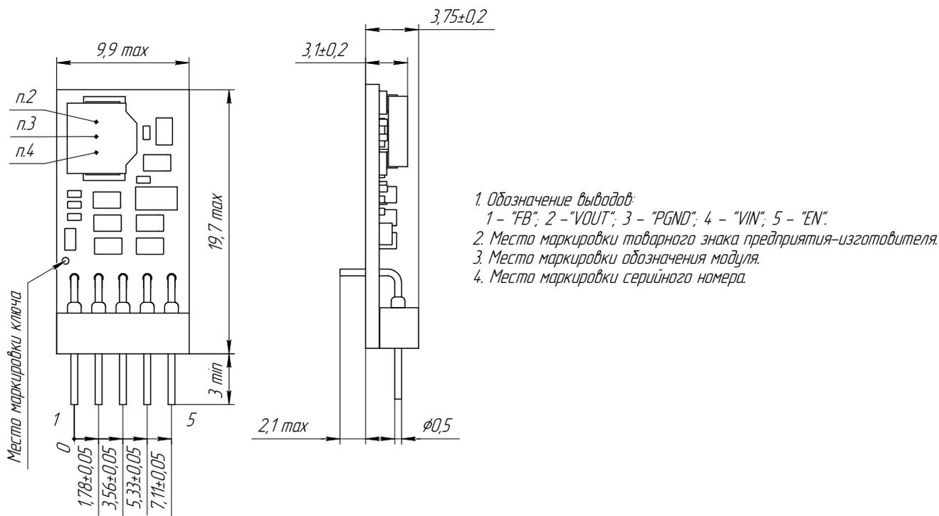
Рис. 31. Габаритный чертёж и обозначение выводов VNA3L0, 87, OSP.
