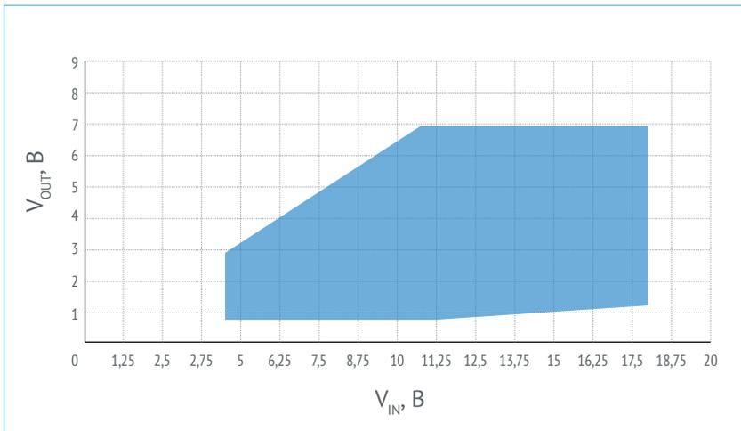
Рис. 14. Допустимый диапазон  $V_{OUT}$  в зависимости от  $V_{IN}$
