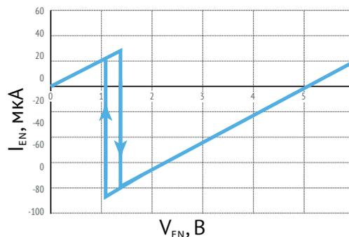
Рис. 16. Типовой гистерезис включения/выключения модуля по выводу EN.
