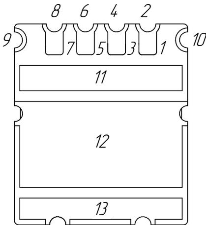
Рис. 1. Расположение выводов модуля VNA3L0,87,0SQ (вид снизу).
