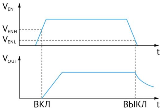
за время не более 2ВКЛ/ВЫКЛ в зависимости от  $V_{EN}$
