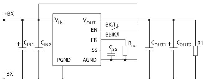
Типовая схема включения стабилизатора VNA3L0,87,0SQ.
