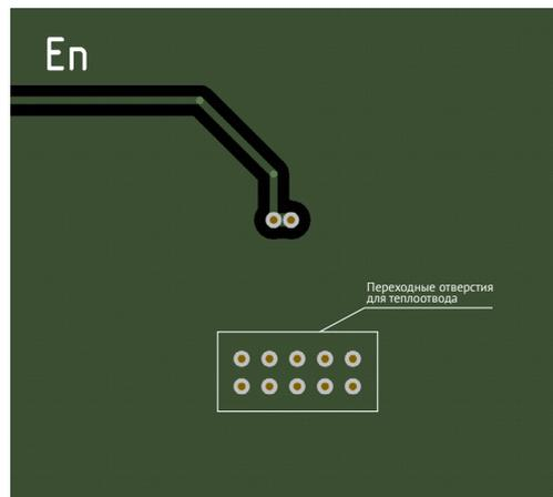
Рис. 23. «Bottom» печатной платы (пример, фрагмент платы).
