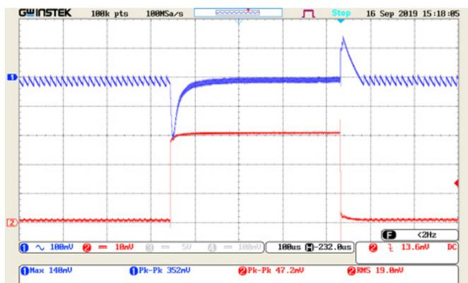
Рис. 7.  $I_{OUT} = 0,1-3 \text{ A}$ ;  $6,5 \text{ A/мкс}$ .
