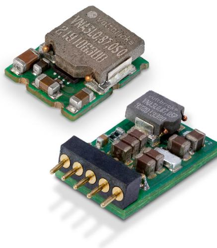
Импульсный стабилизатор напряжения
