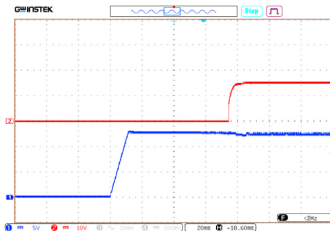
Рис. 8 (б). Осциллограмма установления выходного напряжения с момента подачи входного напряжения.
