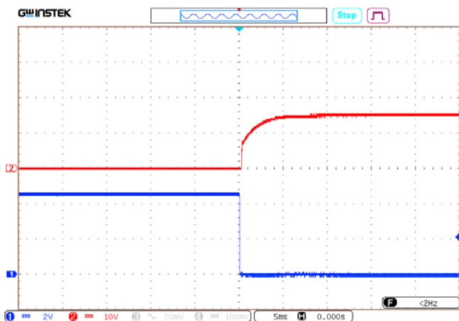
Рис. 8 (а). Осциллограмма установления выходного напряжения с момента подачи команды дистанционного управления.
