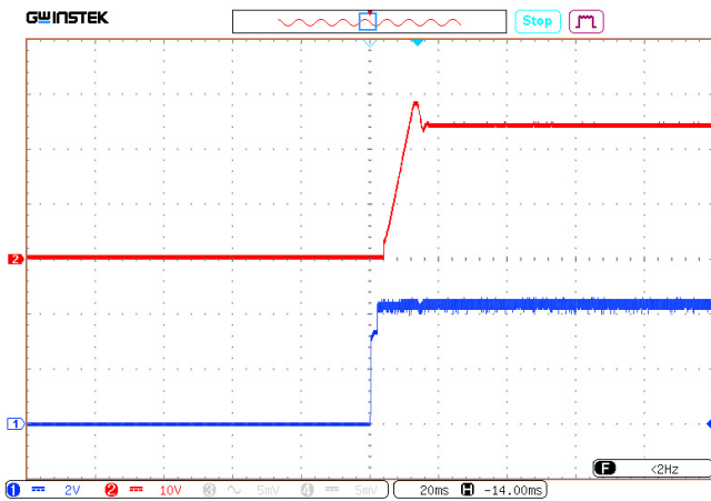
Рис. 24. Установление U_{\text{вых.ном}} с момента подачи ДУ (соединение выводов «ВКЛ» и «-ВХ»).
