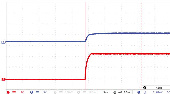
Рис. 8 (а). Осциллограмма установления выходного напряжения с момента подачи команды дистанционного управления.
