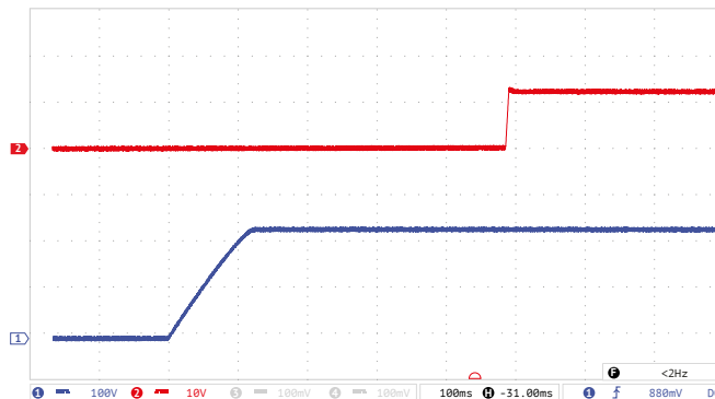
Рис. 8 (б). Осциллограмма установления выходного напряжения с момента подачи входного напряжения.
