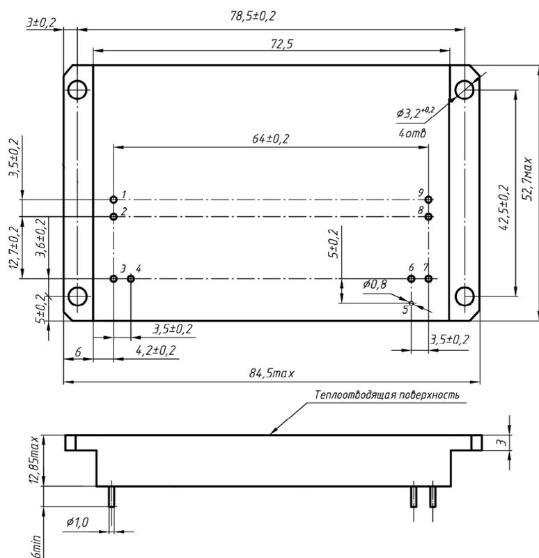
Рис. 13. Исполнение VFA2U, VFA4,5U.
