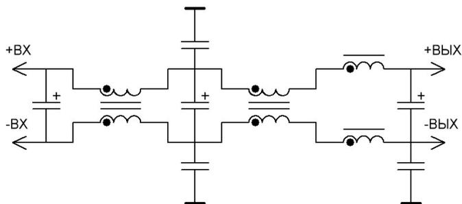
Рис. 4. Функциональная схема VFA.
