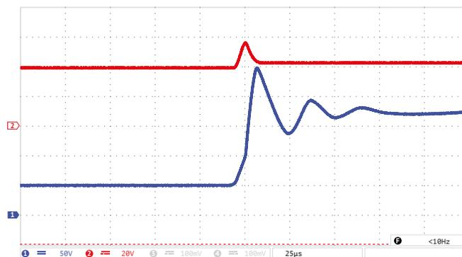
Рис. 7. Осциллограмма выходного напряжения при «коротком» входном перенапряжении.
