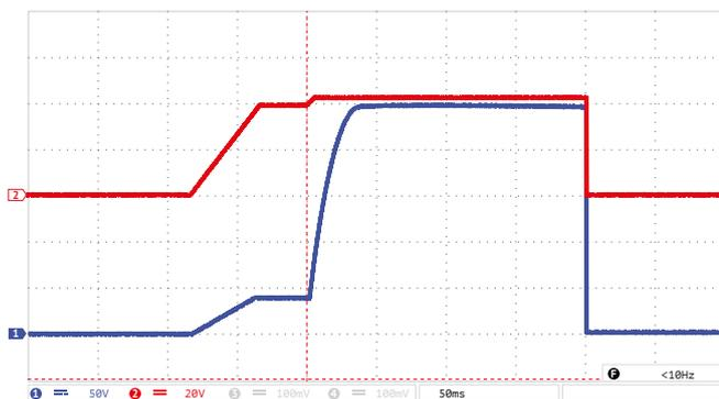
Рис. 6. Осциллограмма выходного напряжения при «длительном» входном перенапряжении.
