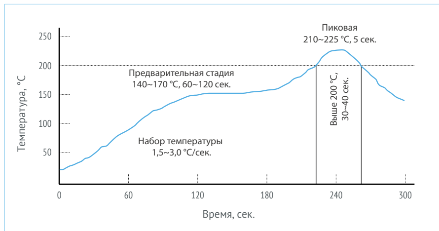
Рис. 25. График и рекомендации по настройке термопрофиля в печи конвекционного нагрева.
